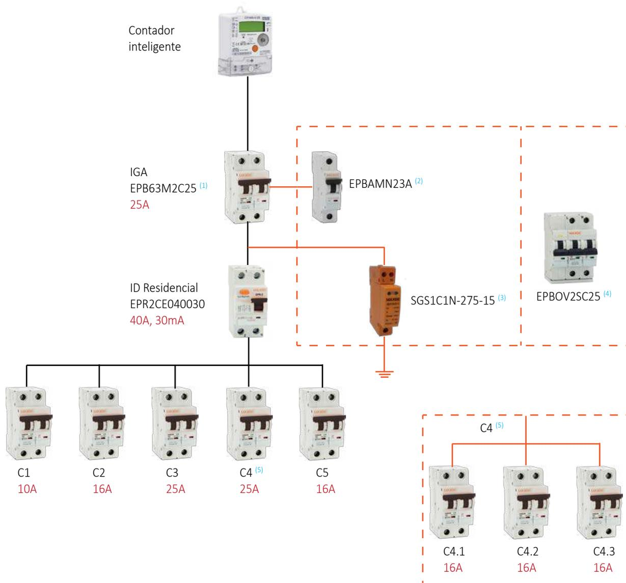
(1) Ejemplo de instalación: Potencia contratada 5,75kW que se corresponde con a l = 25A.
